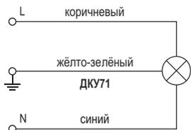
Рисунок 3. Схема присоединения светильника ДКУ71
